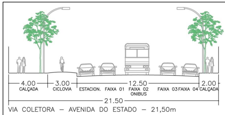
Figura 34. Configuração geral da Via Coletora a ser implantada interligando as áreas institucionais 01 e 02 à extremidade oeste do loteamento.
