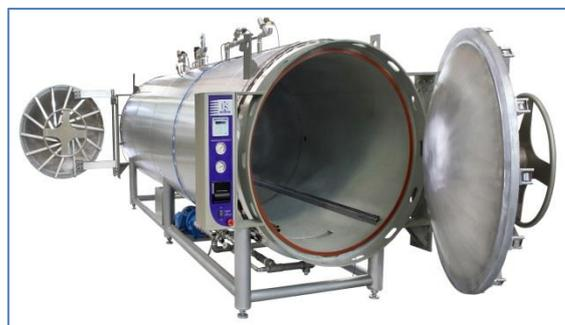
A esterilização a vapor é um processo especial que tem a finalidade de prover probabilisticamente um produto quase livre de todas as formas microbianas mediante a aplicação de agentes físicos (calor, pressão e tempo).
