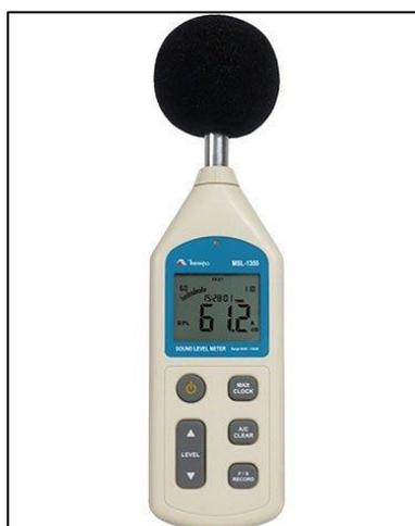
*Figura 8 - Decibelímetro digital MSL-1355B, utilizado nas medições.*
