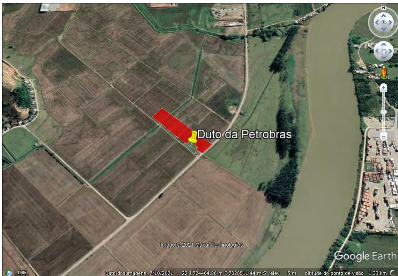
**Figura 01** - Croqui de localização – Terreno representado pelo polígono vermelho (conforme delimitação enviada pelo requerente) e passagem do duto da Petrobras representada pelo marcador amarelo (fonte: *Google Earth*).
