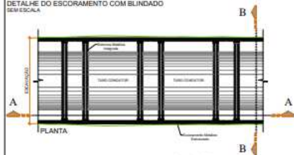
DETALHE DO ESCORAMENTO COM BLINDADO SEM ESCALA
