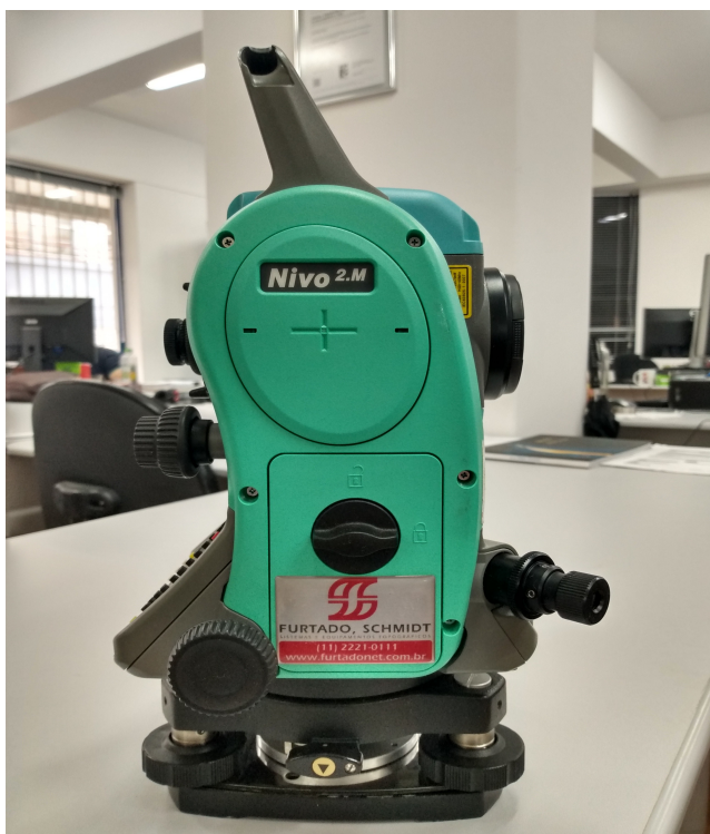
Figura 3.6 – Estação Total – Marca Nikon – Modelo NIVO-2M
