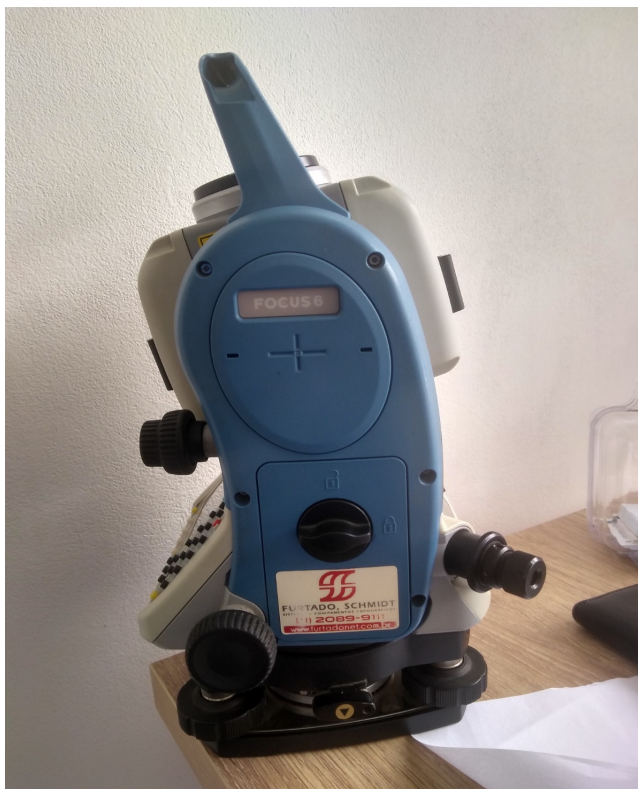
Figura 3.7 – Estação Total – Specetra Precision – Modelo Focus-6 2"
