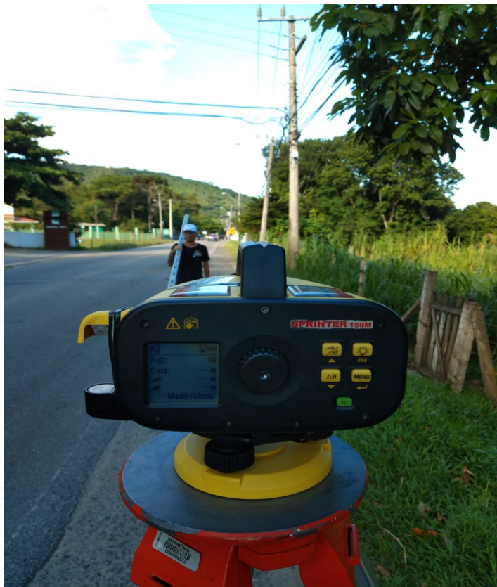
Figura 3.8 – Nível Leica – Modelo Sprint 150
