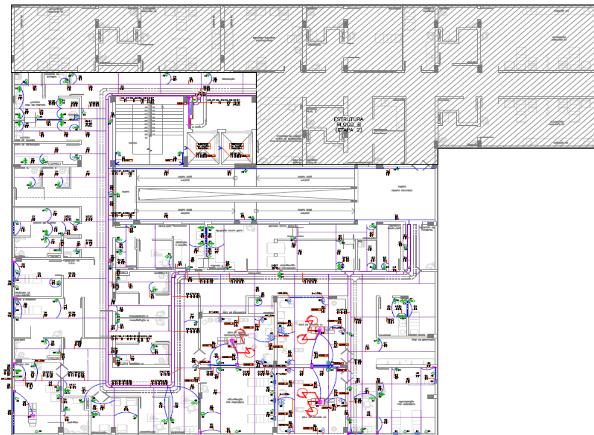
DISPOSIÇÃO DOS ALIMENTADORES E TOMADAS - 2º PVTO. (BLOCO A) ESCALA: 1/75
