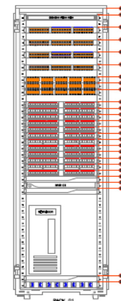
DETALHE RACK DE COMUNICAÇÃO SEM ESCALA
